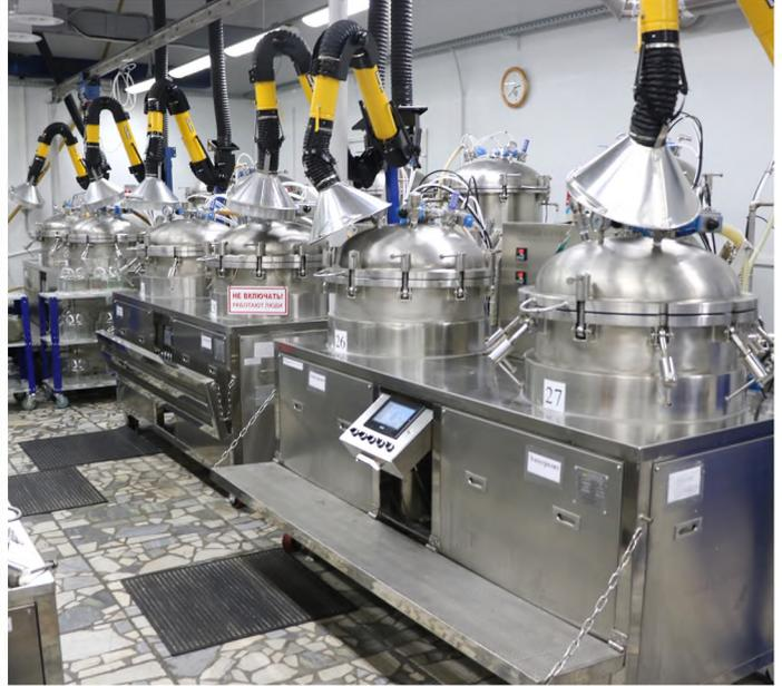
Установки для пропитки секций конденсаторов
